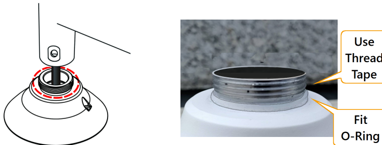
Waterproofing the Pendant Cap
